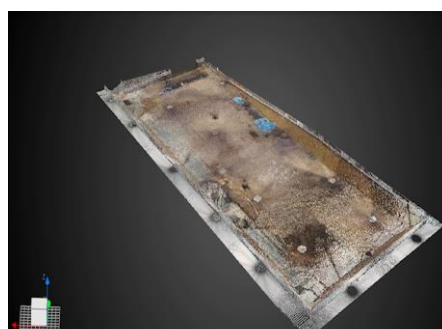
図6 起工測量で得られた 3次元点群データ
