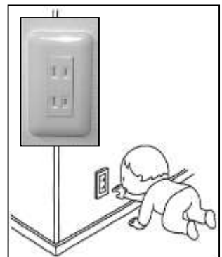
シャッター付きコンセントの設置
