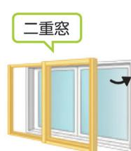
窓は室内外の熱の出入りの約6割を占めるので、窓の断熱改修は効果大。サッシの交換、ガラスの交換、新たに内窓を設置するなどの方法があります。
