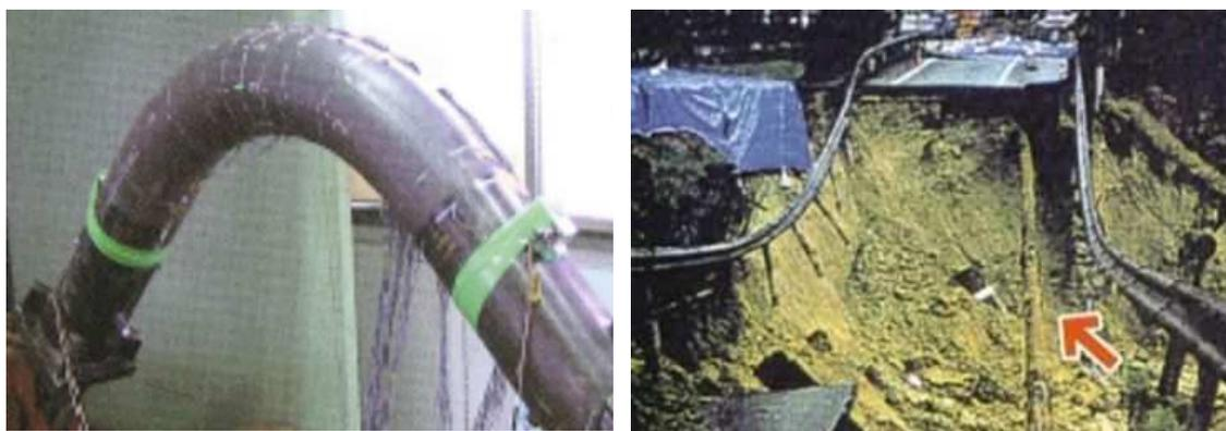
図 3 左) 可とう性のある中圧ガス導管、右) 道路崩壊時も健全な中圧ガス導管
