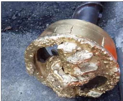
図 13 低耐荷力泥土圧式工法【切削ビット】
