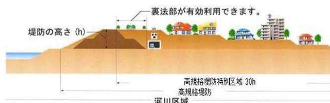
図3-1 高規格堤防整備イメージ
