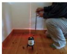
「床の構造を計測する」調査機器
